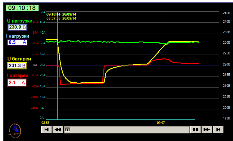
Рис. Экран панели «Графики»
