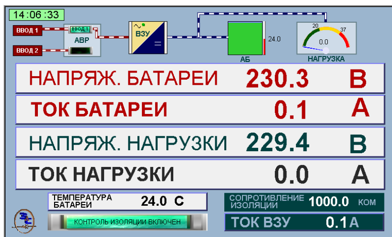
Рис. Экран панели «Приборы»
